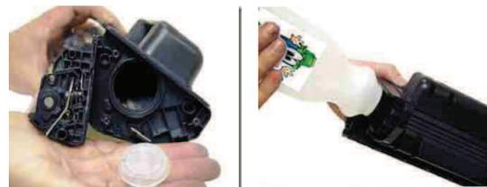
Vous allez ensuite remonter la cartouche. Commencez par remettre les deux parties côte à côte puis mettez le capot du côté gauche. Mettez y deux visse avant de passer au côté droit. Vissez complètement ce dernier avant de mettre les trois derniers visse sur le côté gauche.
